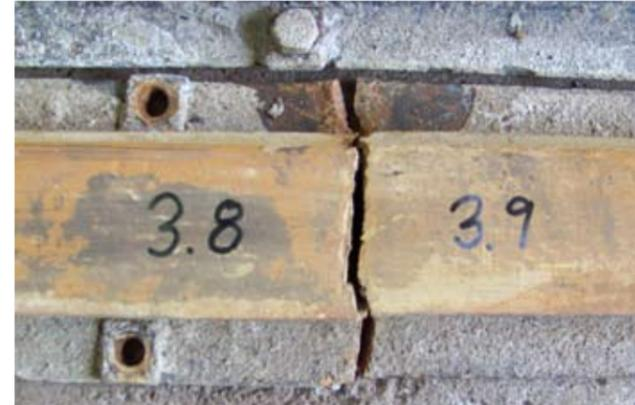
Gebrochene Stahlschienen vom Schleusengrund
